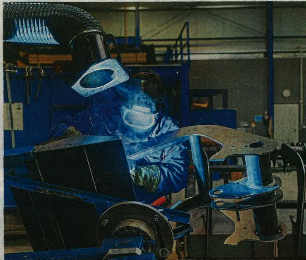
Ein Mitarbeiter der Glandorfer Firma AGU schweißt eine Müllpresse zusammen.
